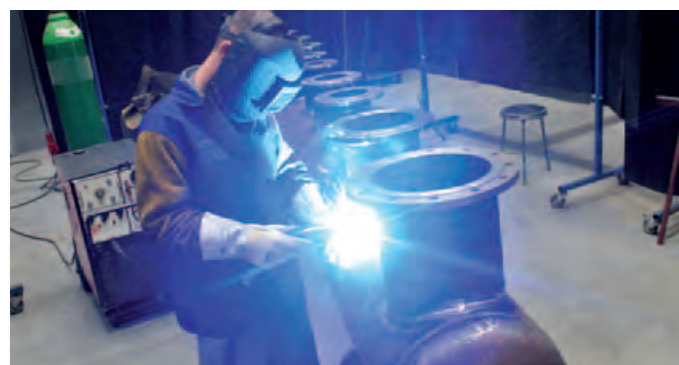
Verteiler-Schweißen nach AD 2000
