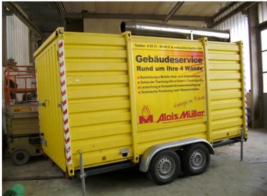
Unsere Heizmobile mit einer Leistung von 170 bis 560 kW sind besonders flexibel, da sie auf einem Anhänger montiert sind. So kommen sie unkompliziert zum Einsatz, wenn schnell Leistung benötigt wird, weil die fest installierte Heizanlage nicht verfügbar ist. Heizmobile bieten eine schnelle Übergangslösung, um Produktionsausfälle zu verhindern, sind aber auch für lange Mietzeiten geeignet. Die temporäre Anmietung bietet Ihnen eine zuverlässige, flexible und kostenoptimierte Heizalternative.
